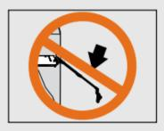
Teleskophebel nicht nach unten drücken, sondern entfernen.
